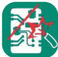
Não remova a placa eletrônica de dentro da caixa plástica quando o equipamento estiver energizado e principalmente quando o veículo estiver em funcionamento a fim de evitar curto-circuito com pontos massa (-) do veículo
