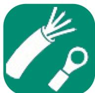
Todas as conexões elétricas devem ser realizadas com conectores apropriados ou com solda estanho (60-40) e também deve se observar a correta isolamento das mesmas;
